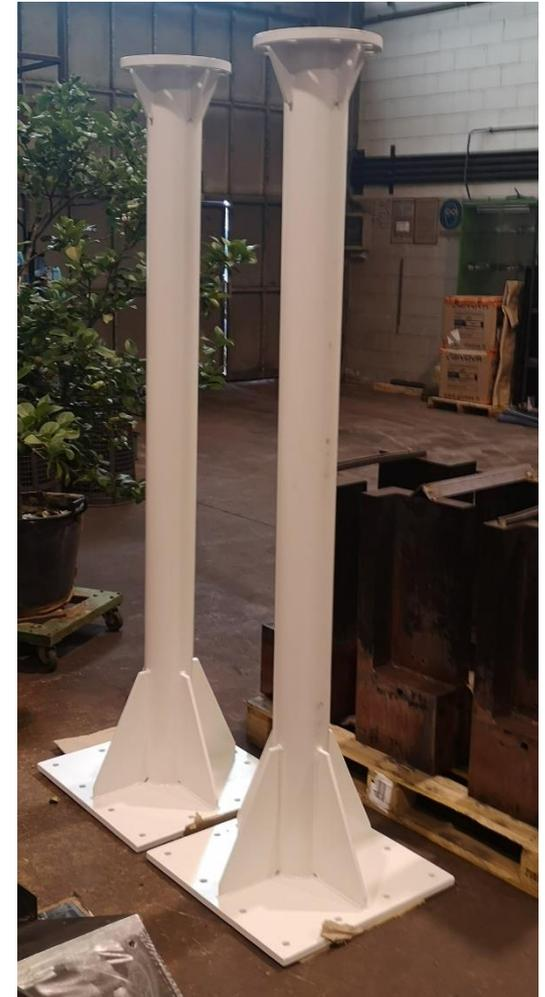
El poste del aerogenerador de eje vertical debe respetar el diseño de la brida de conexión del propio generador, es posible realizar postes para cubiertas planas o postes a diseñar después de la evaluación.
